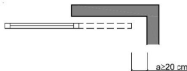
Figura 2.1 Holgura para evitar atrapamientos
